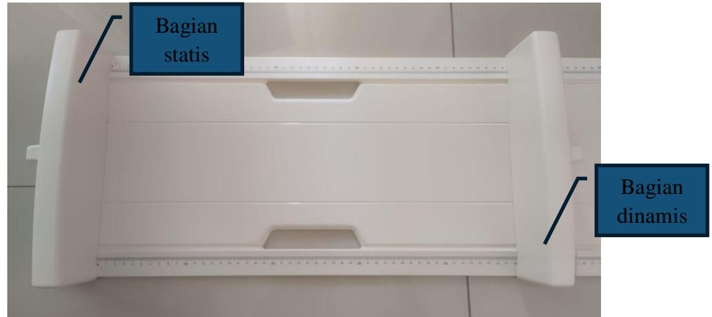
Gambar 1.1. Alat pengukur panjang badan
